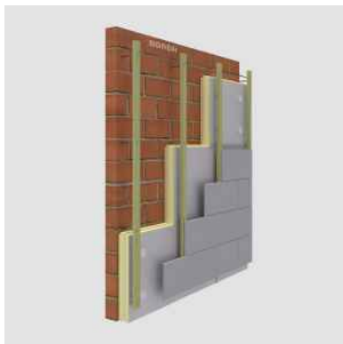
Houtsectie verticaal geplaatste kepers:
